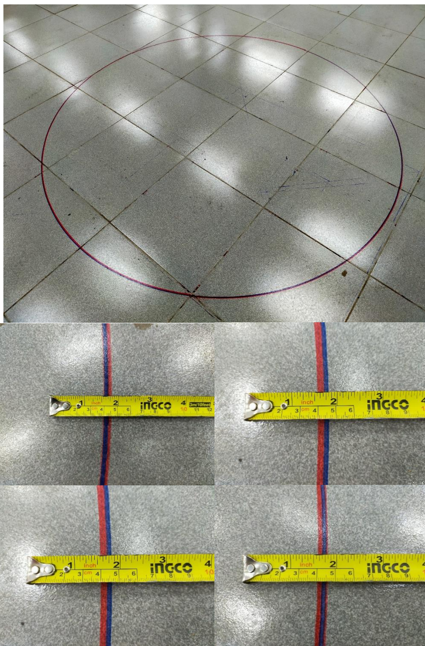
Hình 5.15: Kiểm tra độ chính xác với quỹ đạo hình tròn đường kính 1.6m với 2 trường hợp
