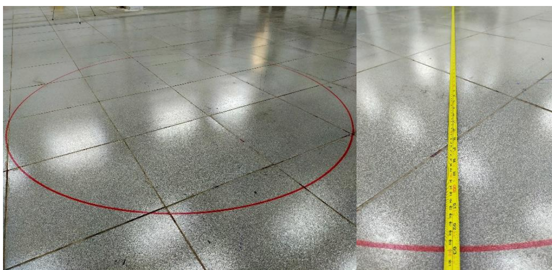
Hình 5.14: Kiểm tra độ chính xác vị trí với quỹ đạo hình tròn đường kính 1.6m
